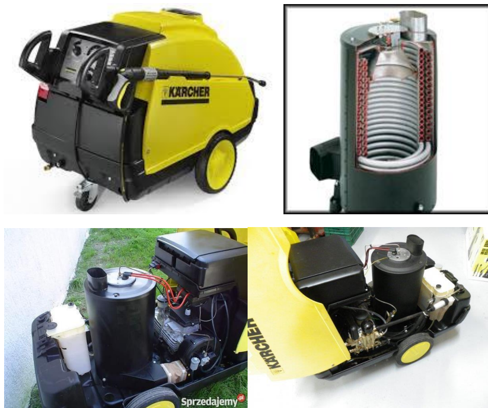
Figura 6: Máquina de lavar de alta pressão com aquecimento de água
